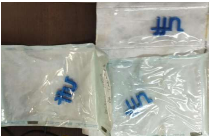
FIGURA 11: Materiais impressos em PLA esterilizados em autoclave em ciclo longo de menor temperatura e ciclo curto de alta temperatura, e esterilização com peróxido de hidrogênio, não apresentando deformidades significativas.
