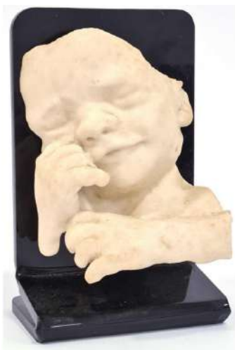
FIGURA 6: Binder Jetting (BJT). Face fetal a partir de exame de ultrassonografia (28 semanas).
