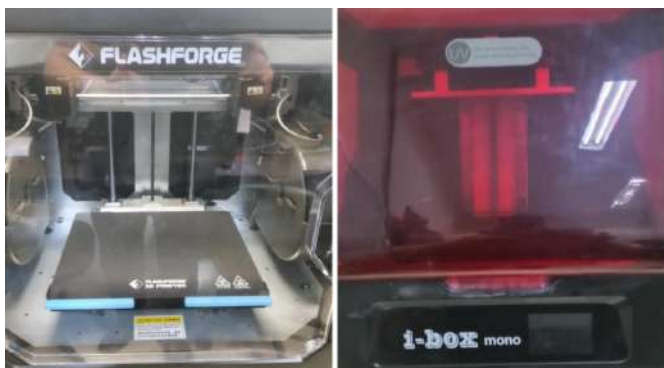
FIGURA 2: Fotos de impressoras 3D tipo FDM e Resina, respectivamente.
